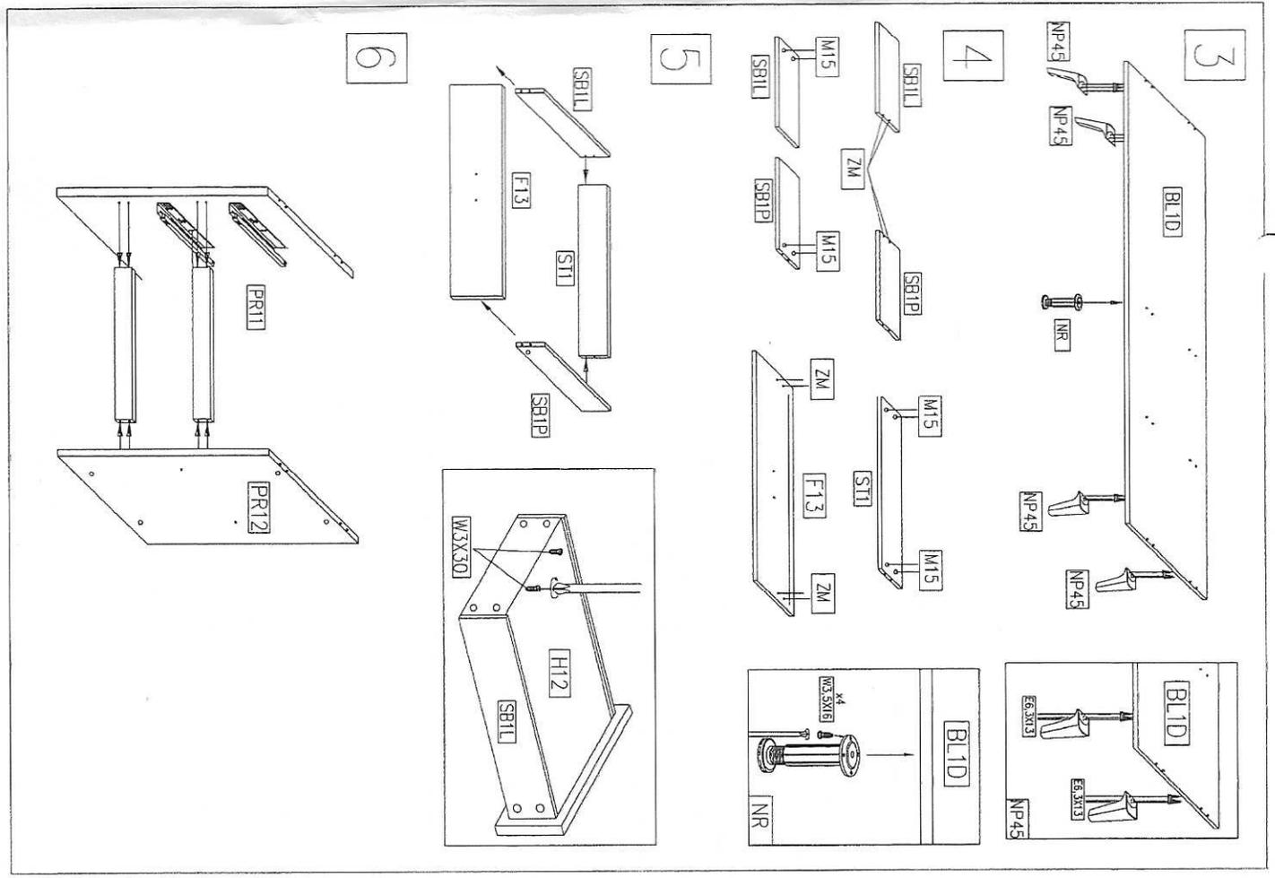
Placer les éléments sur le socle inférieur B1L, B1P, PR11, PR12.
