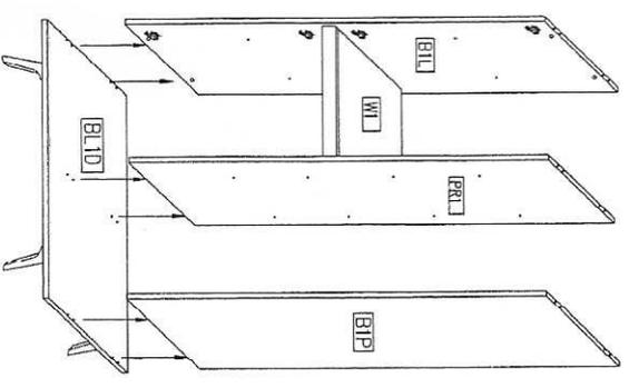
Monter le plateau supérieur. Fixation par goujon/excentrique.
